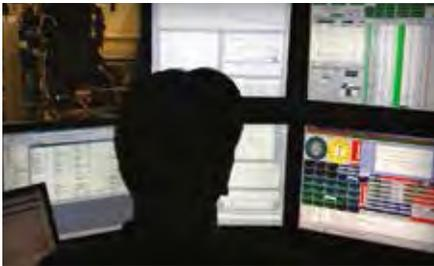
Alle Außenbordmotoren werden in unserem Labor, wo Techniker die Motorleistung und alle wichtigen weiteren Motorparameter überwachen können, intensiv getestet.
