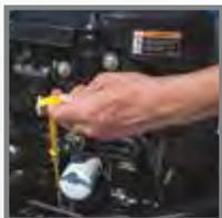
Für das Austauschen des Kraftstofffilters sind keine Werkzeuge erforderlich und es kann in weniger als einer Minute ausgeführt werden. Der QR-Code bietet Verknüpfungen zu Ihrem Handy für hilfreiche Anwendungsvideos. Und dank dem wartungsfreien Ventiltrieb von Mercury benötigen Sie keine kostspielige Einstellung des Ventilspiels
