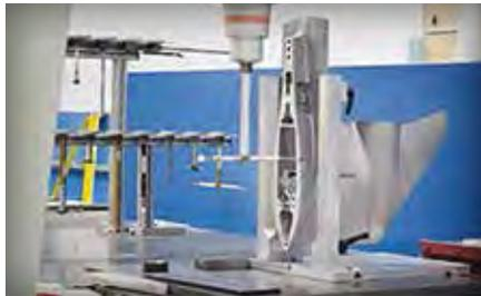
Aus der Fertigung werden stichprobenweise Einzelteile entnommen und auf ihre Übereinstimmung mit dem Originaldesign hin überprüft.
