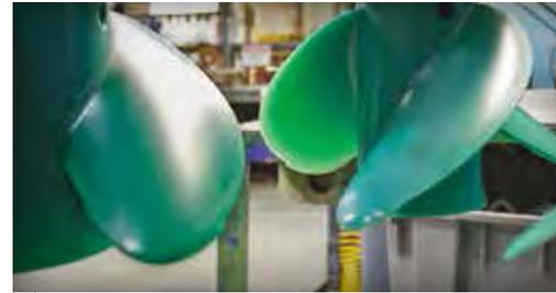
Mercury fertigt die Propeller mit den besten Leistungswerten. Alle unsere Edelstahlpropeller beginnen als ein genaues Wachsabbild des Endprodukts.
