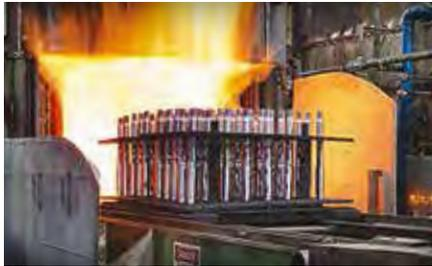
Mercury verfügt über eine eigene Wärmebehandlungsanlage, in der die Komponenten so widerstandsfähig gemacht werden, dass sie auch in den anspruchsvollsten Anwendungen bestehen.
