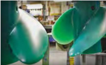
Mercury Marine fertigt die Propeller mit den besten Leistungswerten. Alle unsere Edelstahlpropeller beginnen als ein genaues Wachsabbild des Endprodukts.
