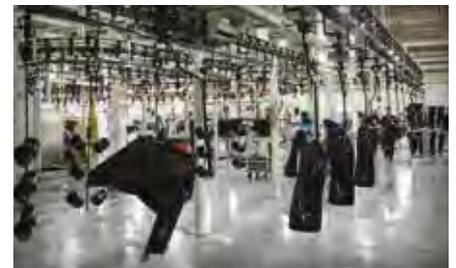
Dank der Verwendung der korrosionsbeständigsten Materialien und der exklusiven mehrschichtigen Lackierung und Beschichtung von Mercury sind die FourStroke-Motoren hervorragend vor Salzwasser geschützt.
