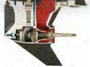
Das Gehäuse der OptiMax Außenbordmotoren ist hydrodynamisch optimiert, um Effizienz und Höchstgeschwindigkeit zu steigern. Die patentierten frontseitigen Wasserzuläufe halten den Motor unabhängig von der Schaftlänge kühl, stabile Zahnräder und Antriebskomponenten erhöhen die Haltbarkeit.
