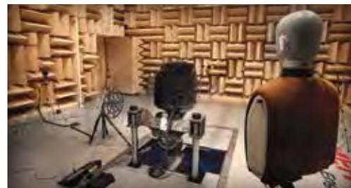
Im Mercury Sound Lab optimieren und stimmen Ingenieure den Klang der Motoren ab und reduzieren Geräusch, Vibration und Rauheit (NVH) auf ein Minimum.
